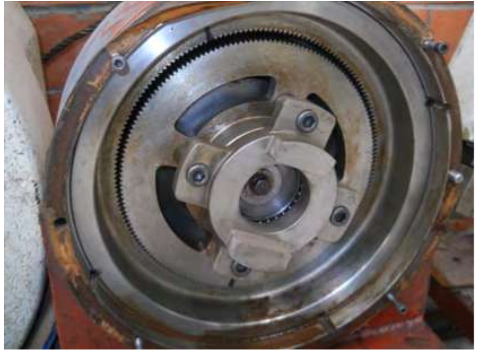
Figura 2. Transmisión cicloidal de engranes convencionales
