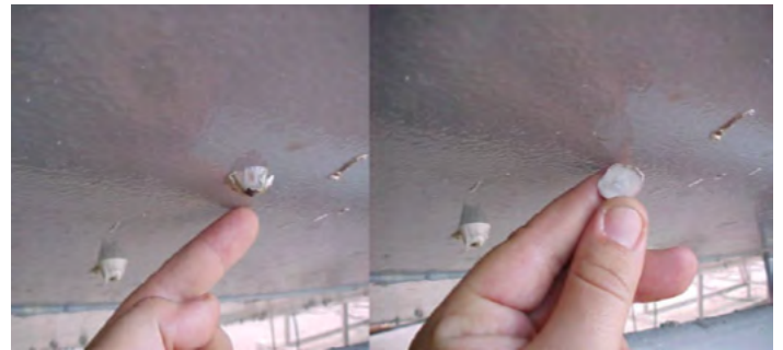
Recubrimiento sin biocidas con baja energía superficiales evitando la fijación de organismos, (Rodríguez, 2019).
